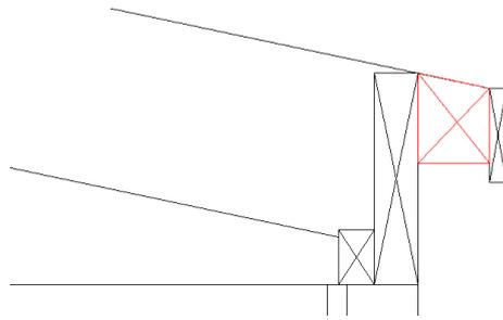
**6.** Montieren Sie danach die Giebelsparren (6). Diese werden direkt außen an die Giebelkeilen festgeschraubt. Folgen Sie der Oberkante des Riegels (12) und der vorderen Querpfette.
