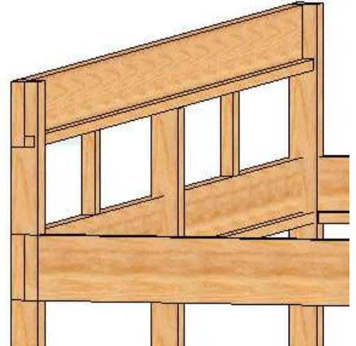
**3. Leimen und schrauben Sie die 45x45-Leiste (10) an der Unterkante der vorderen Querpfetten-Innenseite sowie an den beiden Seitenbalken fest. Auf der hinteren Querpfette montieren Sie die 45x70-Leiste (11). Der Leim ist im Lieferumfang nicht enthalten.**
