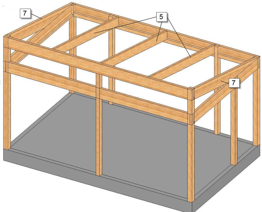
**5.** Ruuvaa kiinni kattotukipuut (12) takimmaisen tukiparrun yläpuolelle keskikattopalkkien jatkeeksi. Ne tulee sekä ruuvata että liimata. Liima ei sisälly! Ruuvaa kiinni katonrajan lauta.
