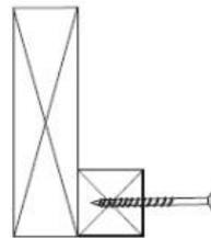
**4.** Monter gavkilerne (7) oven på sidebjælkerne og mod de forreste stolper. De fastgøres i stolperne og sidebjælkerne. NB! Gavkilen er ingen tagbjælke, og der må ikke monteres tagprofil på den! Fortsæt derefter med de midterste tagbjælker (5). Fordel dem iht. c/c-mål fra din tegning. Udskæringen i de midterste tagbjælker placeres på bjælkernes planker.
