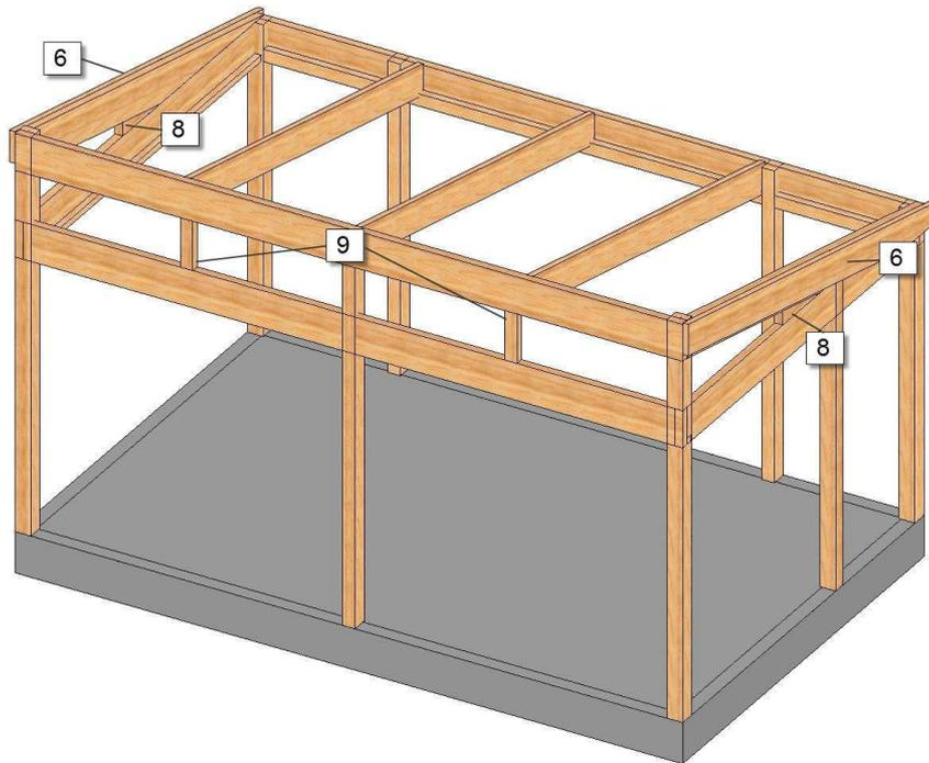
**6.** Monter derefter gavlens tagbjælker (6). De skrues fast direkte uden på gavlkilerne. Følg overkanten af tagskægget og den forreste bjælke.
