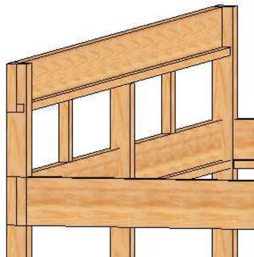
**3.** Limma och skruva fast regel(10) 45x45 mm i nederkant av insida främre bärlina, samt på de båda sidobalkarna. På den bakre bärlinan monteras regel 45x70(11).
